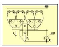
Max. load :  $F_1=30 \text{ kg } F_2=60 \text{ kg } F_3=120 \text{ kg}$
