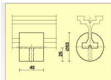
Dient zum Abschluss der Vorhangbahnenden. Aus weichem Guss-VULKOLLAN. Die Befestigung wird durch Gewindestift ermöglicht.
